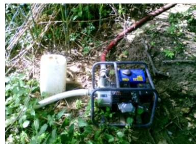
Exemple de prélèvement par moto-pompe.
